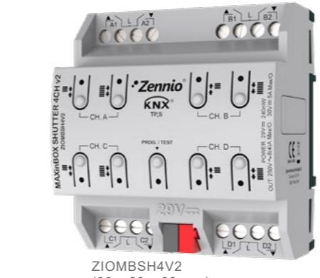
Ενεργοποιητής κινητήρων για τοποθέτηση σε ράγα DIN (4,5 στοιχεία) με 4 κανάλια επάνω/κάτω. Περιλαμβάνει πρόγραμμα για 20 ανεξάρτητες λειτουργίες λογικής και επιτρέπει χειροκίνητο έλεγχο και ένδειξη κατάστασης μέσω LED στο κάλυμμα. Πρόσθετα εξαρτήματα: μετατροπέις AC/DC κινητήρων.
