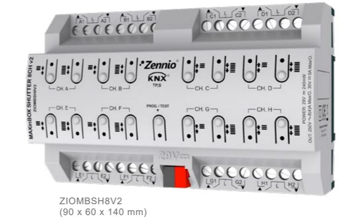
Ενεργοποιητής κινητήρων για τοποθέτηση σε ράγα DIN (8 στοιχεία) με 8 κανάλια επάνω/κάτω. Περιλαμβάνει πρόγραμμα για 20 ανεξάρτητες λειτουργίες λογικής και επιτρέπει χειροκίνητο έλεγχο και ένδειξη κατάστασης μέσω LED στο κάλυμμα. Πρόσθετα εξαρτήματα: μετατροπέις AC/DC κινητήρων.
